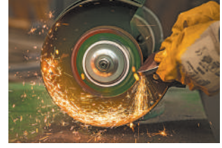
Рис. 8.2. Швидкості руху іскор феєрверка, бризок з-під коліс автомобіля, металевих ошукорк напрямлені по дотичній до кола. Саме в цьому напрямку частинки продовжують свій рух після відриву
